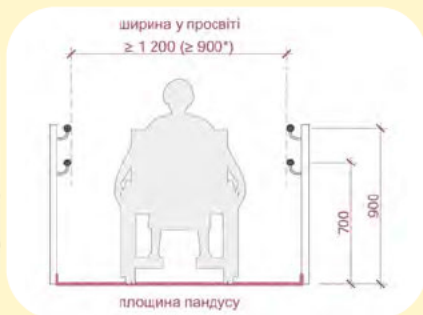
Приклад облаштування пандусу (розміри вказані у мм)
