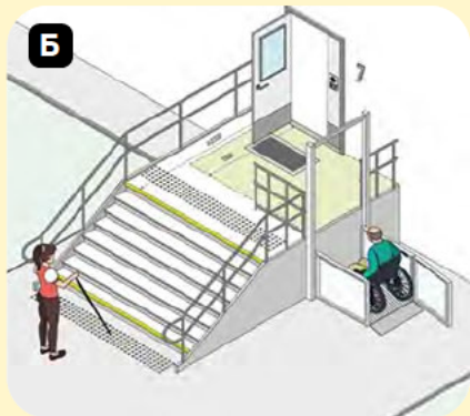
Варіанти влаштування підймального пристрою для ганків: а) рух вздовж сходів, б) вертикальний підйом
